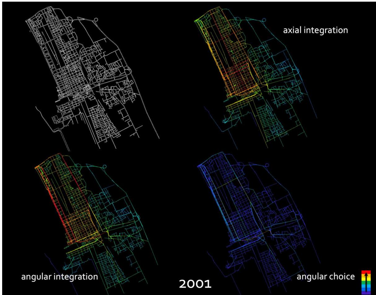
Fig. 4 – Distribuzione degli indici di integrazione globale e di scelta calcolati con *axial analysis* sulla *axial map* e con *angular segment analysis* sulla *segment map* di Viareggio al 2001
