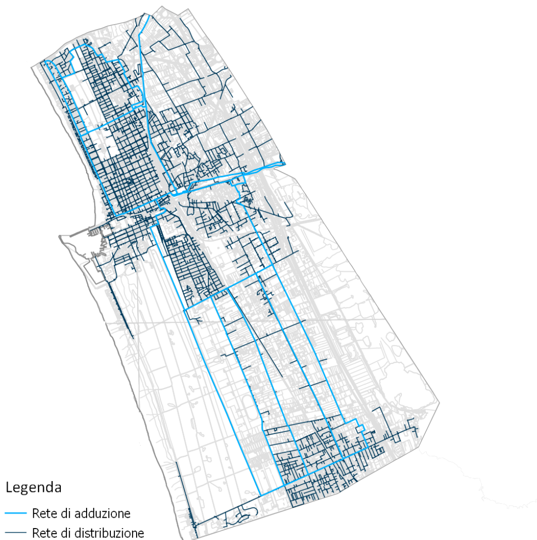
Fig. Rete acquedottistica del Comune di Viareggio. Fonte: rielaborazione dati GAIA spa
