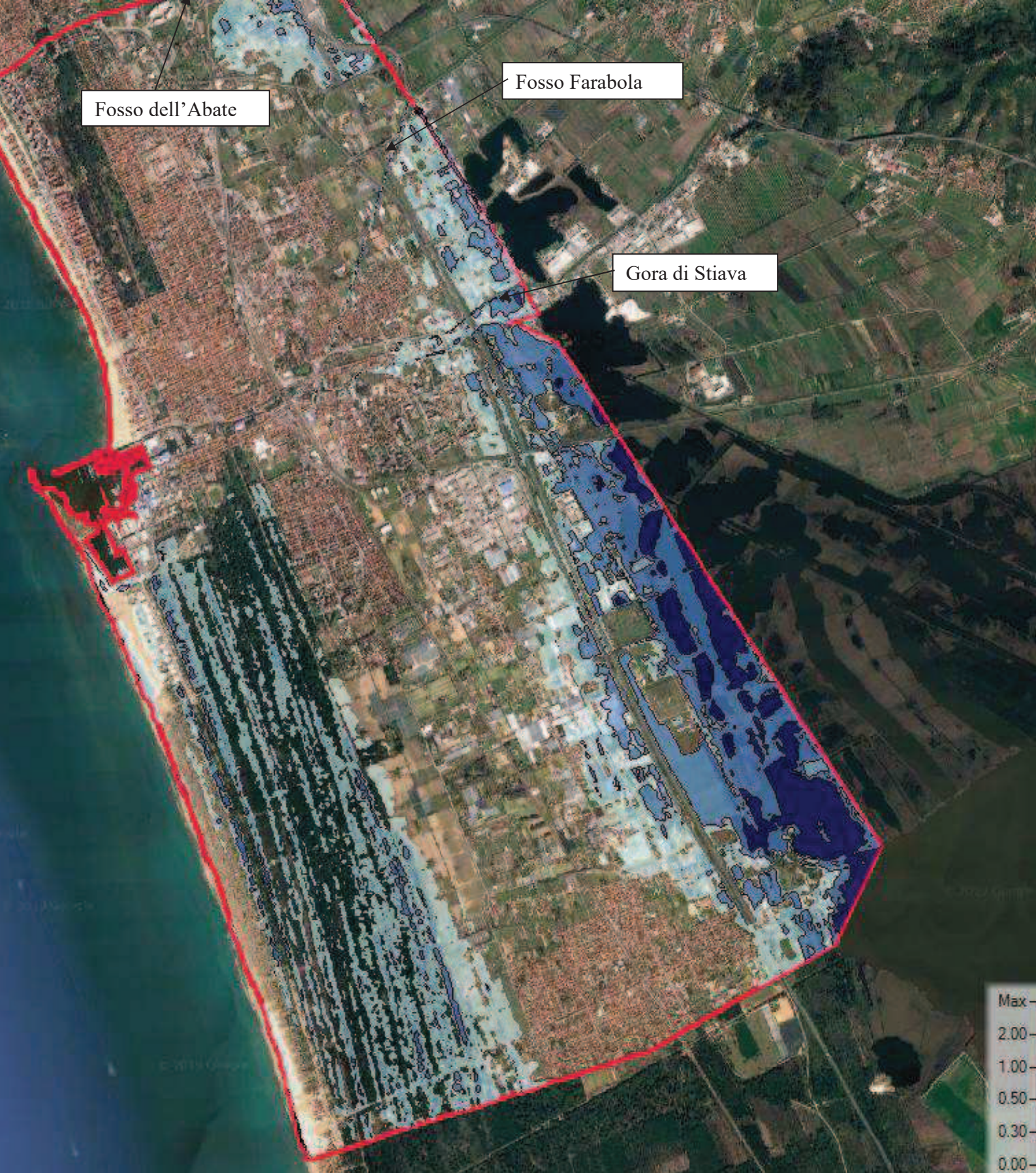
-aree allagabili per evento Tr=200 anni derivate dal presente studio su immagine satellitare di tutto il territorio comunale (confine evidenzia
